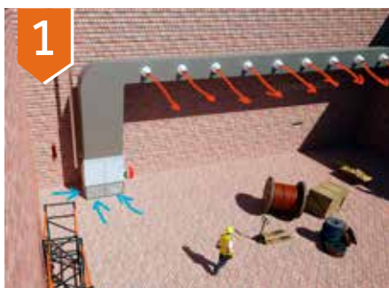
Generador de aire caliente con impulsión de aire mediante conductos y conos de alta inducción.
