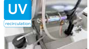
Tratamiento de agua mediante UV
