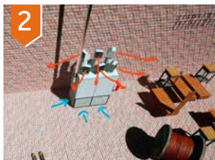
Generador de aire caliente con bocas de impulsión rotativas.
