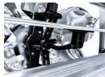
Mecanismo centrífugo para la apertura y cierre de la compuerta
